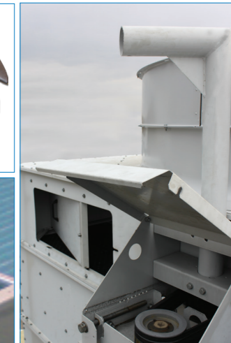
Portello d'ispezione scorrevole apribile verso l'interno. Motore con adattatori esterni e paranco di rimozione*.
