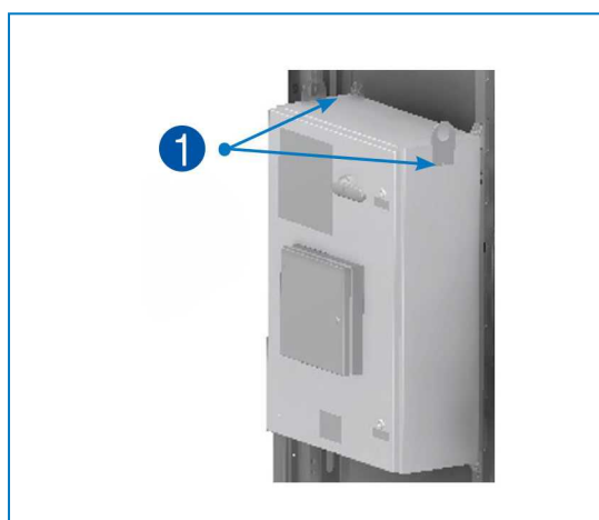
Fig. 8 Pannello del sistema di controllo iPilot™ - 1. Orecchiette di sollevamento del quadro di comando
